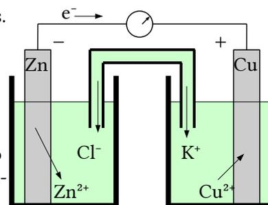
Los dos electrodos estarían conectados, mediante cables, a un voltímetro para medir la f.e.m. de la pila. El sentido de circulación de los electrones será desde el polo negativo (ánodo Zn) hacia el polo positivo (cátodo Cu) mientras que los iones fluirán por el puente salino para mantener la neutralidad eléctrica.
