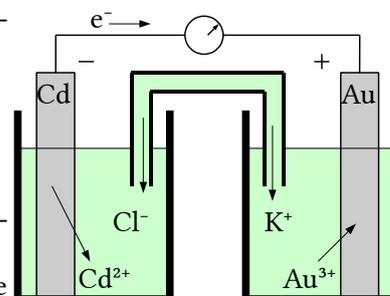
Los dos electrodos estarían conectados, mediante cables, a un voltímetro para medir la f.e.m. de la pila.
