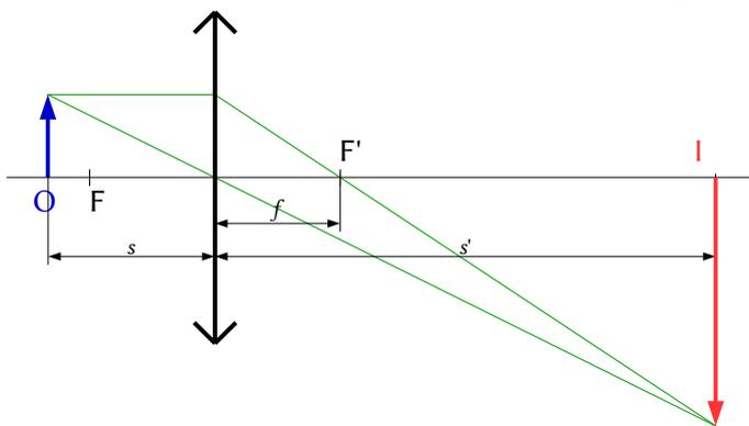
Se dibuja un esquema de lente convergente (una línea vertical rematada por dos puntas de flechas) y se sitúa el foco  $F'$  a la derecha de la lente.
