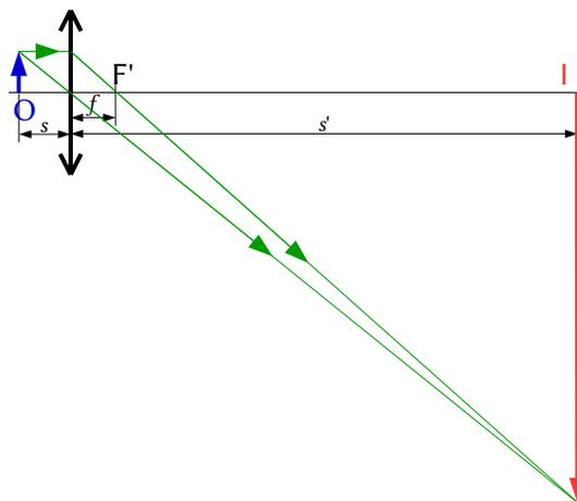
c) La potencia de la lente es la inversa de la distancia focal (expresada en metros) y puede calcularse de la ecuación de las lentes.
