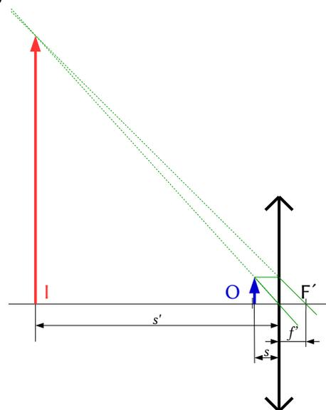
El punto de corte es el correspondiente a la punta de la imagen **I**. Se dibuja una flecha vertical en ese punto.
