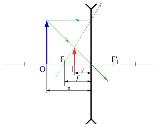
Se dibuja de forma que su prolongación pase por el foco de la izquierda F, un punto simétrico al foco F'.
