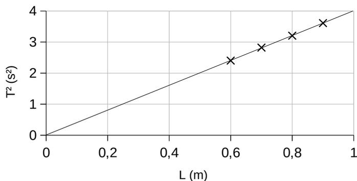
2. Explica cómo se puede determinar la aceleración de la gravedad utilizando un péndulo simple, e indica el tipo de precauciones que debes tomar a la hora de realizar la experiencia.
