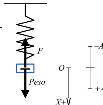
c) Para obtener la ecuación de energía potencial elástica, sin cálculo integral, se dibuja la gráfica  $F/x$  y se admite que el trabajo de la fuerza elástica entre el origen y un punto cualquiera de elongación es el área bajo la gráfica. Para un desplazamiento elemental,  $d x$ , el trabajo de la fuerza valdría el área elemental bajo la gráfica  $F/x$ .
