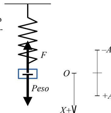
5. Una partícula de masa  $m = 0,1 \text{ kg}$ , sujeta en el extremo de un resorte, oscila en un plano horizontal con un M.A.S., siendo la amplitud  $A = 0,20 \text{ m}$  y la frecuencia  $f = 5 \text{ s}^{-1}$ . En el instante inicial la posición es  $x = A$ . Calcula para  $t = T / 8 \text{ s}$ :
