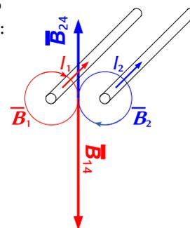
El campo magnético creado por un conductor rectilíneo es circular y su sentido viene dado por la regla de la mano derecha: el sentido del campo magnético es el de cierre de la mano derecha cuando el pulgar apunta en el sentido de la corriente.
