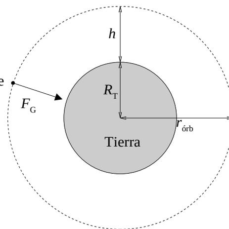
En muchos casos la trayectoria del satélite es prácticamente circular alrededor del centro del astro. Como la fuerza gravitatoria es una fuerza central, la aceleración solo tiene componente normal,  $a_N$ . Al no tener aceleración tangencial, el módulo,  $v$ , de la velocidad lineal es constante y el movimiento es circular uniforme. La aceleración normal, en un movimiento circular uniforme de radio  $r$ , se obtiene de la expresión:
