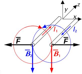
El campo magnético creado por un conductor rectilíneo es circular y su sentido viene dado por la regla de la mano derecha: el sentido del campo magnético es el de cierre de la mano derecha cuando el pulgar apunta en el sentido de la corriente.
