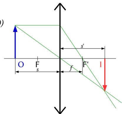
Se dibuja un esquema de lente convergente (una línea vertical rematada por dos puntas de flechas) y se sitúa el foco  $F'$  a la derecha de la lente.
