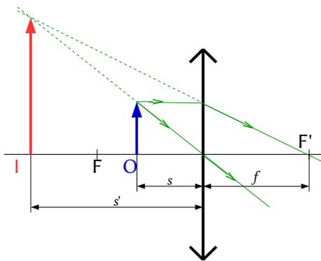
Si colocamos el objeto a una distancia menor que la distancia focal no se forma imagen en la pantalla porque los rayos no se cortan después de atravesar la lente. Prolongando los rayos obtenemos un punto de corte que corresponde a la imagen virtual, que no se ve en la pantalla,
