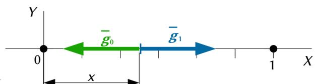
La fuerza de atracción gravitatoria entre dos masas puntuales o esféricas,  $M$  y  $m$ , viene dada por la ley de la gravitación de Newton.  $G$  es la constante de la gravitación universal y  $\vec{u}_r$  el vector unitario en la línea que une las masas.
